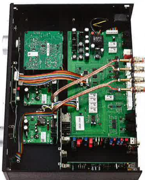
Kühlkörper und Riesentrafo Fehlanzeige: Der acht Kilogramm leichte AVM repräsentiert modernsten Verstärkerbau mit effizienter Class D-Technologie
